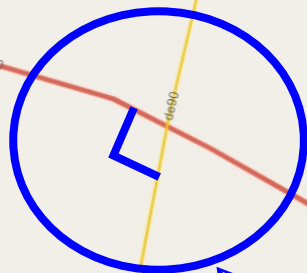
Rys. 1- miejsce połączenia gazociągu stalowego DN100 z gazociągiem PE de90 kier. Ząbrowo-Rusinowo
